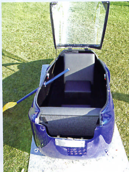
Schnell kann der Innenraum mit verschiedenen Sitzvarianten ausgestattet werden. Der Umbau erfordert kein Werkzeug.
