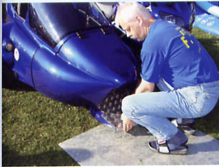
So schnell wird das Boot demontiert: Vordere und hintere Sicherung lösen, ...
