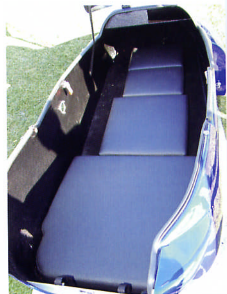
Schnell kann der Innenraum mit verschiedenen Sitzvarianten ausgestattet werden. Der Umbau erfordert kein Werkzeug.
