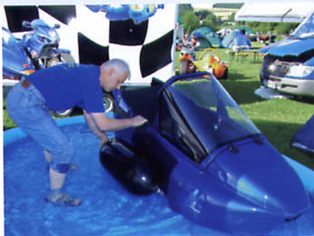
Seitenschwimmer stabilisieren das Boot bei leichtem Seegang.
