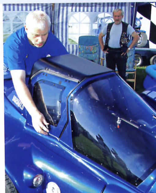
Eine Meisterleistung für sich: Mit wenigen Handgriffen wird das Hardtop aus dem Kofferraum herausgefaltet.
