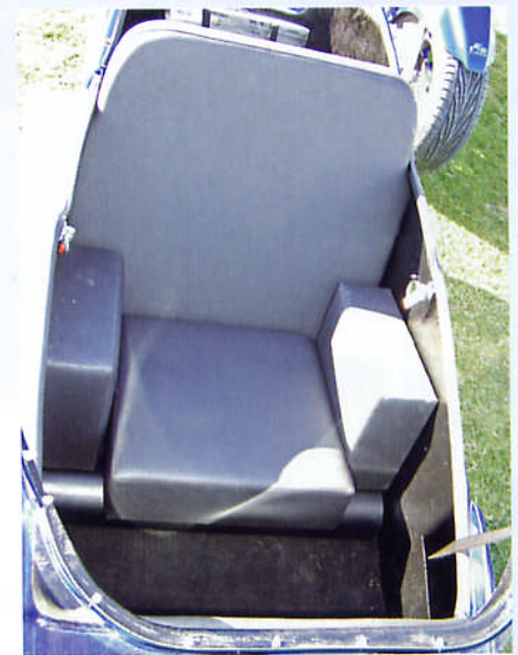
Schnell kann der Innenraum mit verschiedenen Sitzvarianten ausgestattet werden. Der Umbau erfordert kein Werkzeug.
