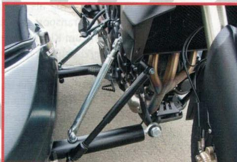
Speziell: Ein Hydraulikdämpfer zwischen Motorrad und Boot reduziert die Kippneigung bei harten Lastwechseln im Schwenkermodus.
