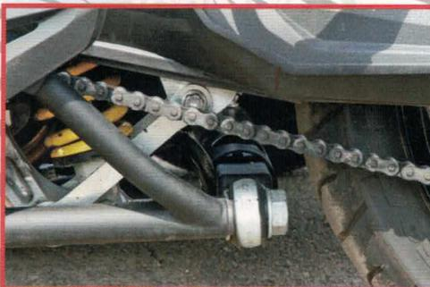
Servo-Effekt: Um das Bootsrad in Kurven mitlenken zu lassen, liegen die Kugelgelenke außerhalb der Motorrad-Mitte.
