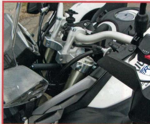
Listige Lösung: Durch Verstellen der Gabelneigung an der oberen Brücke sind Nachlaufwerte von 91 oder 35 Millimetern wählbar.
