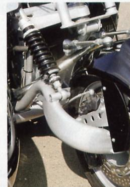
Eine für alle: Die Fahrwerktechnik mit Achsschenkellenkung passt an die allermeisten Zugmaschinen
