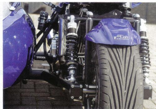
**Klassische Optik:** Die Lenkkräfte werden über exzentrisch gelagerte Schubstreben in die Lenknabe geleitet. So lässt sich der Nachlauf optimal einstellen. Die Konstruktion erlaubt die Verwendung einer vorde- ren Doppelscheibenbremsanlage, was für optimale Verzögerung selbst aus höchstem Tempo sorgt.
