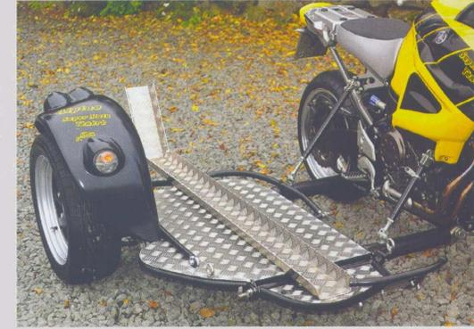
Fahrzeugtransporter: Die Ladeschiene bietet Motorrad oder Fahrrad sicheren Stand. Zum Aufladen lässt sich das Frontblech bis zum Boden klappen.
