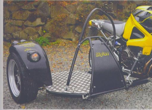
Solider Standpunkt: Der Bügel gibt Halt bei Turneinlagen im Gelände. In dieser Konfiguration lassen sich auch Lasten bis 120 Kilo festschnallen.
